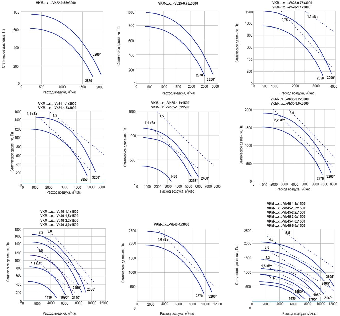
Аэродинамические характеристики вентиляторов приведены при плотности перемещаемых газов  $\rho=1,2 \text{ кг/м}^3$ :
